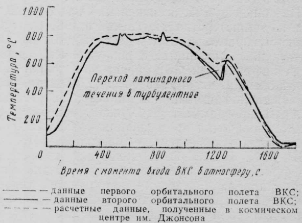
Рис. 2. Изменение нагрева подфюзеляжной поверхности ВКС на начальном участке спуска в атмосфере (термопара смещена от носка к центру аппарата на расстояние, равное 25% l_{\Phi} )
