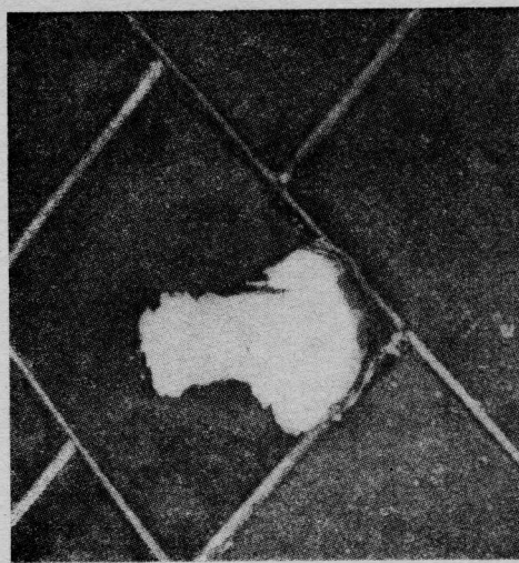
Рис. 14. Повреждение теплозащитной плитки на подфюзеляжном щитке в первом орбитальном полете ВКС «Колумбия»
