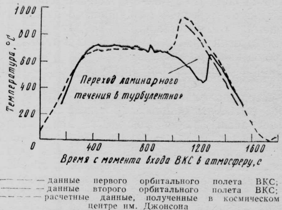
Рис. 3. Изменение нагрева подфюзеляжной поверхности ВКС на начальном участке спуска в атмосфере (термопара смещена от носка к центру аппарата на расстояние, равное 70% l_{\Phi} )
